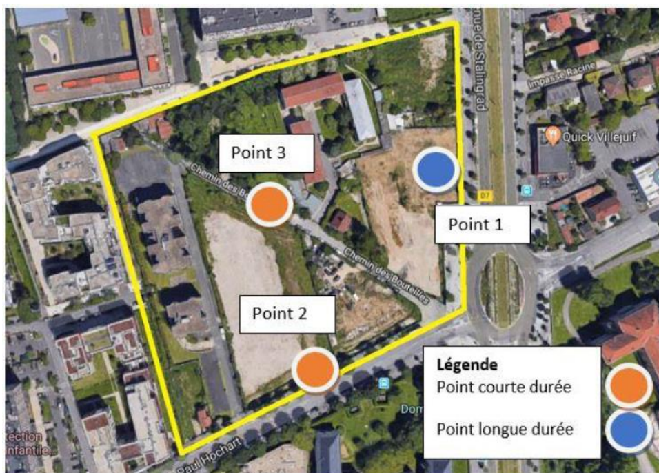
Figure 55 : Emplacement des points de mesure sur le site (source : ARUNDO ACOUSTIQUE)
