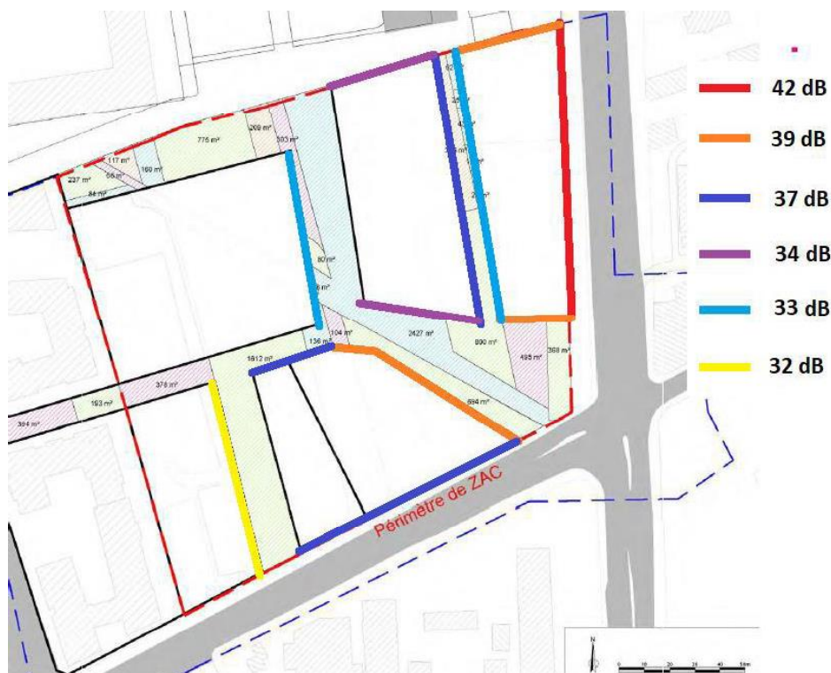
Figure 77 : Isolement de façades préconisés (Source : ARUNDO Acoustique)
