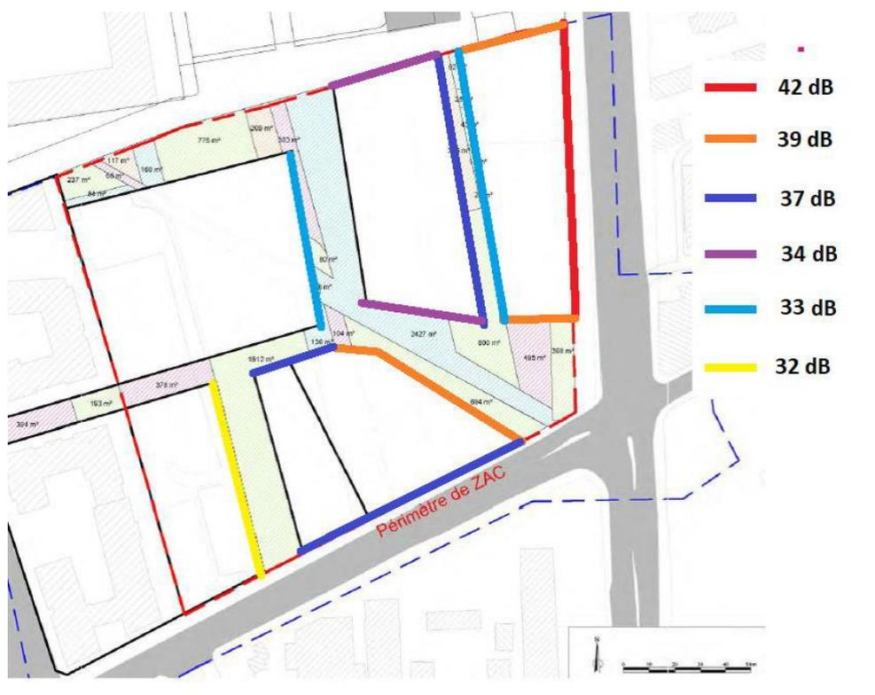
Figure 11 : Isolement de façades préconisés (Source : ARUNDO Acoustique)
