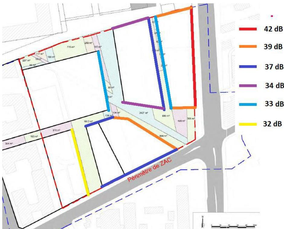
**Figure 7 : Isolement de façades préconisés (Source : ARUNDO Acoustique)**
